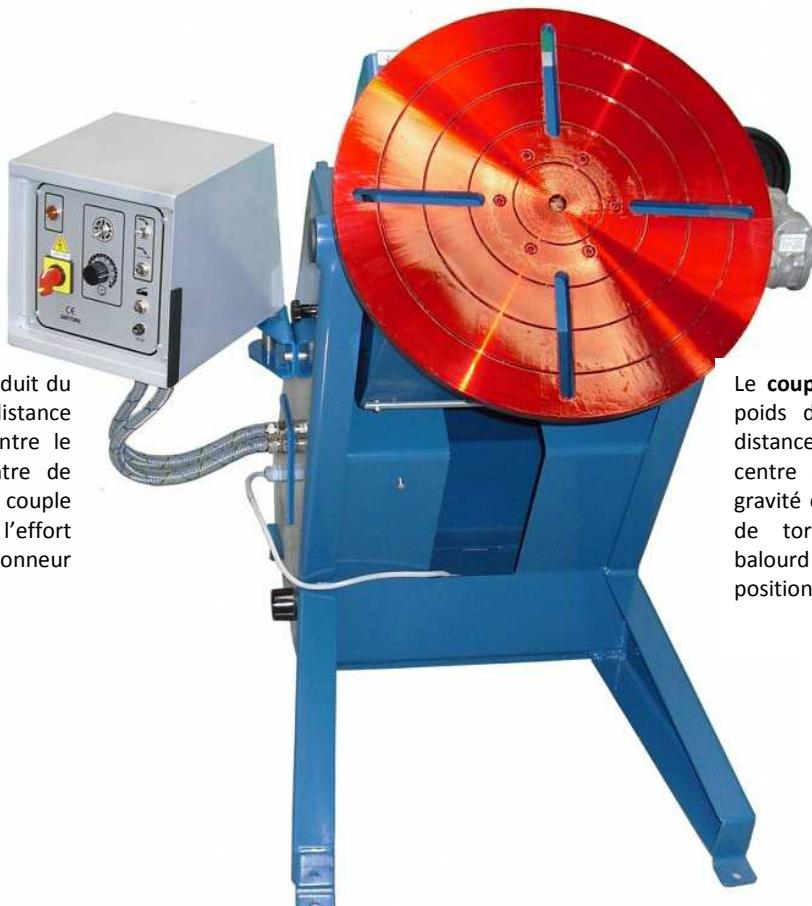
Le **couple de flexion** est le produit du poids de la pièce (en kg) par la distance perpendiculaire au plateau, entre le centre du plateau et le centre de gravité de la pièce (en m). Ce couple de flexion est représentatif de l'effort que doit reprendre le positionneur lorsque le plateau est incliné
