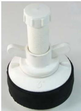
Bouchon livré avec 1 opercule à visser pour fermeture axe creux et 1 opercule avec olive pour branchement tuyau et alimentation en gaz (Sur les petits diamètres, le branchement en gaz se fait directement sur l'axe fileté, seul l'opercule de fermeture est livré)
