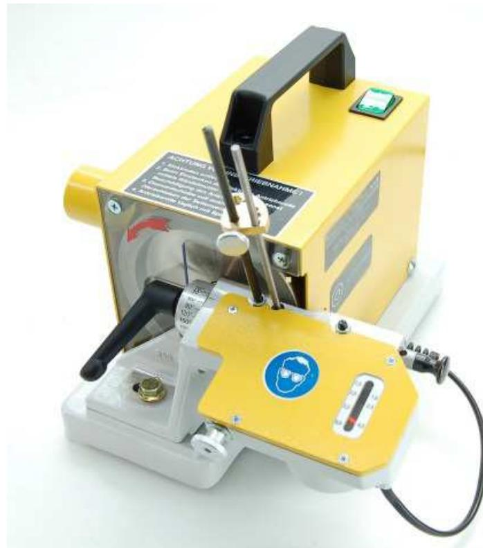
La mise en rotation de l'électrode (325 tours par minute) est assurée par une motorisation électrique. La force de poussée de l'électrode contre la meule est assurée par gravité. Il n'y a pas d'intervention manuelle, ce qui garantit une excellente reproductibilité de l'affutage :
