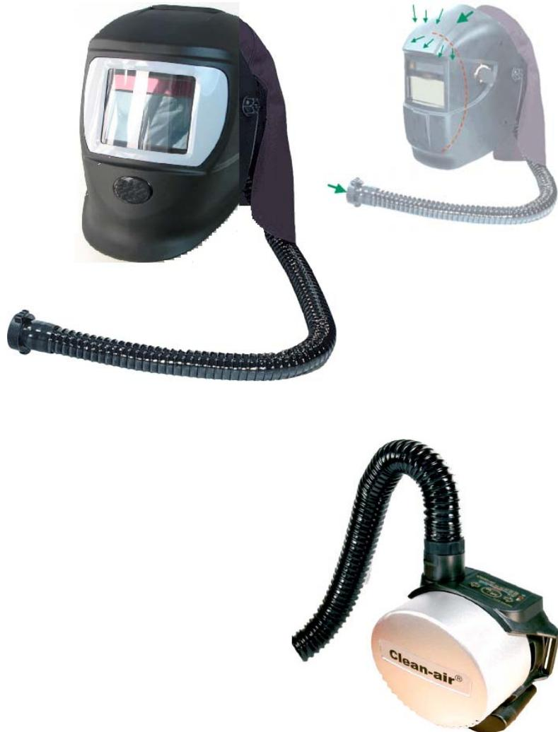
Cette cagoule ventilée permet d'amener de l'air recyclé et filtré, prélevé dans le dos du soudeur (en dehors de la zone polluée) au niveau du visage du soudeur, d'entretenir à ce niveau une légère surpression, empêchant les fumées et les gaz de soudage de pénétrer dans cette zone. La tête du soudeur est "encadrée" au niveau du visage par la cagoule et à l'arrière par un habillage tissu ignifugé, serré autour de la face (trait pointillé).
