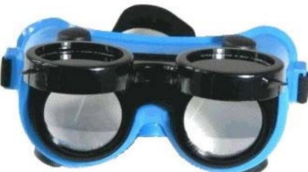
Lunettes masque BASIQUE, dotées d'une ventilation indirecte et d'une face relevable. Conforme EN 175. Monture en PVC. Oculaires incolores vissés sur la face fixe (EN166). Oculaires vissés "soudeur" indice 5 (EN169) sur la face relevable. Poids : 145 grammes
