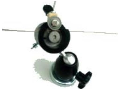
**Capteur vitesse de fil DV25M**, positionné sur support aimanté polyarticulé pour une mise en place facilitée.
