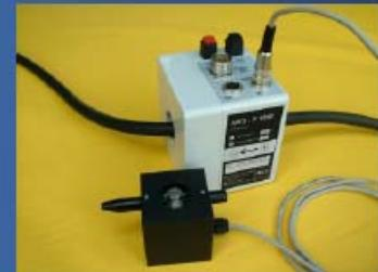
Capteur P1000 pour mesure tension et intensité de soudage jusque 100V et 1000A (courant continu ou alternatif)
